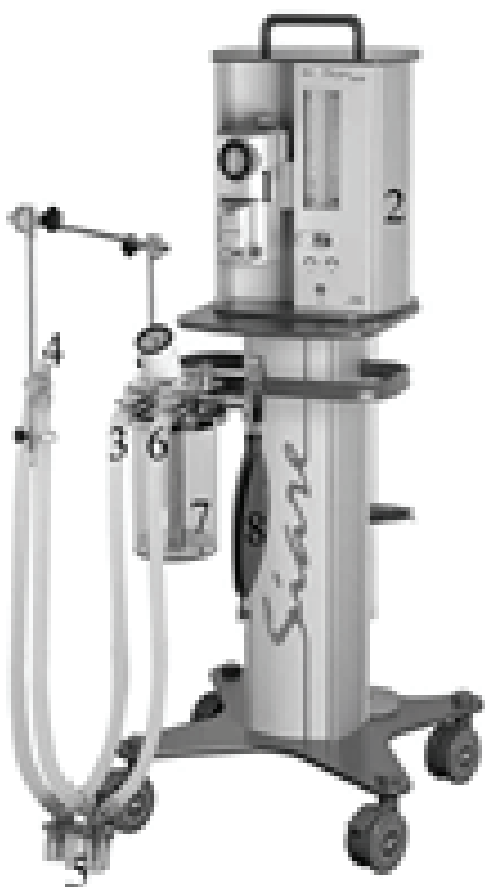
Рис. 19. Современный наркозный аппарат. (1 – испаритель; 2 – блок ротаметров; 3 – клапан вдоха и шланг вдоха; 4 – адаптер; 5 – влагосборники; 6 – клапан выдоха и шланг выдоха; 7 – адсорбер; 8 – дыхательный мешок) [1].
